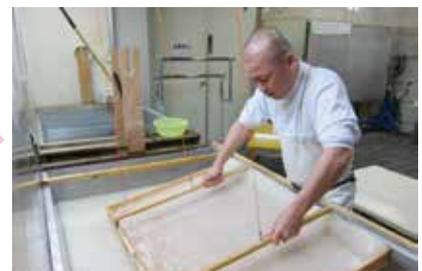
舟(水槽)の中で繊維と水、粘液を混ぜます。すけた簀桁という専用の道具を前後左右に揺らし、和紙を漉きます。漉いた和紙を重ね、水を絞り天日干しで乾燥させたら和紙の完成です。
