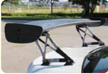
車体を地面に押し付ける力の生成や、安定した走行ができるよう、車体の後部に取り付けられているものです。これにより車体が浮き上がりにくく、スピードが出ても横転せずにカーブを曲がることができます。
