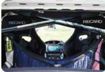
競技中、車が横転しても潰れないよう補強する金属製のバー。選手たちの命を守る大事な役目を果たします。
