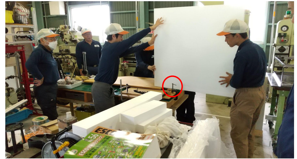
発泡スチロールカッターを使って材料を必要な寸法に切断 (写真は1000mmの材料を950mmに切断)
