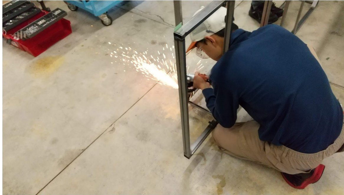
グラインダーによる、溶接部の仕上げ
