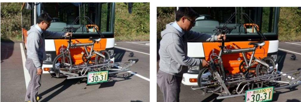
利用者は自転車をラックのレールに載せ手で押さえる。バス乗務員が固定用のレバーをタイヤ上部にかけて固定する。
