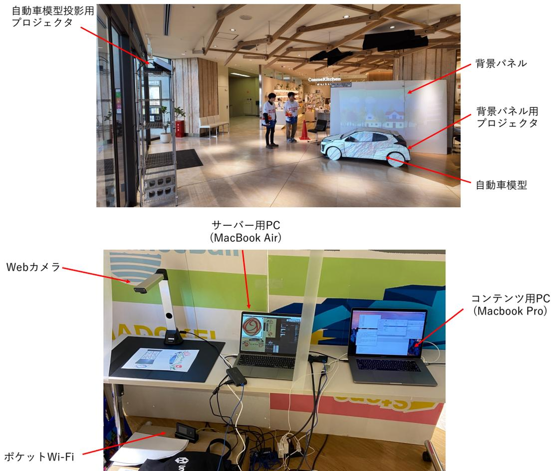
図2：コンテンツのための機材の設置
