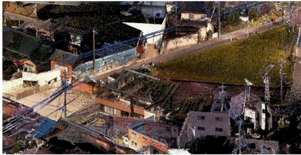
図6 3D スキャナによる測量点群データ
