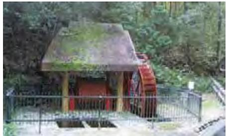
トロミル水車とは、サバ土の入った「トロミル」というドラム缶のようなものを水車の動力で2昼夜回転させ、良質な陶磁器の原料となる石粉をつくる装置です。
