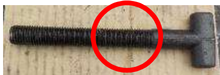
水道管をつなげるボルト
