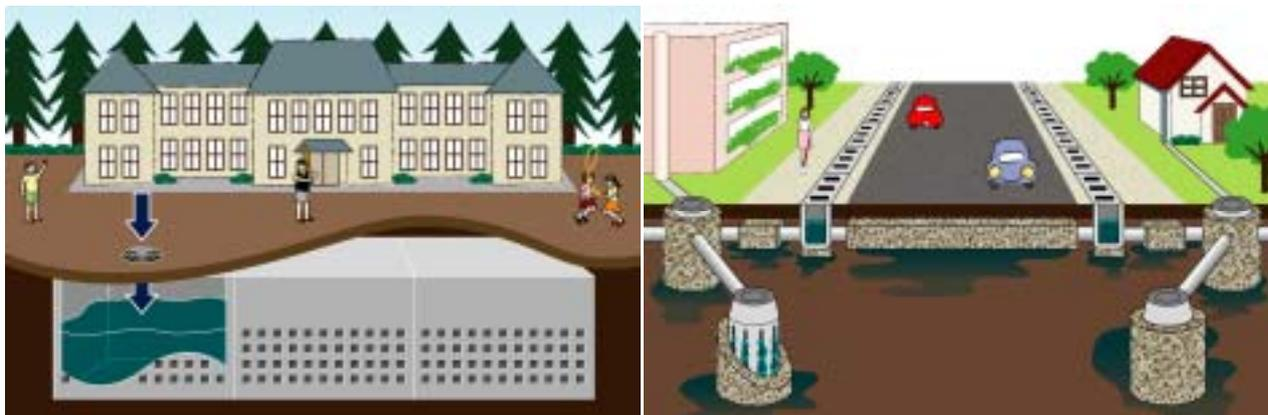
図 4-6 雨水貯留施設(左：校庭貯留)、浸透施設(右：浸透ます、トレンチ等)
