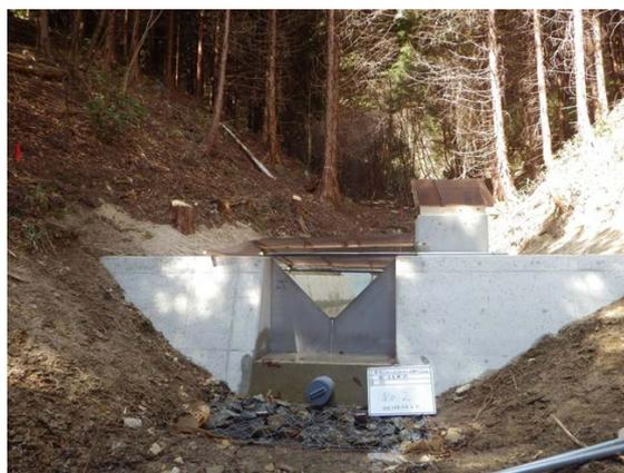
大洞市有林に処理流域（A-1）、対照流域（A-2）と2流域を設置し、それぞれにおいて気象、流量、樹冠遮断、表面流、土砂流出量及び水質の観測装置を設置し、観測を開始しました。今後はこの調査に基づいて、間伐等実施効果をデータに基づいて明らかにし、間伐推進の一助としていきます。
