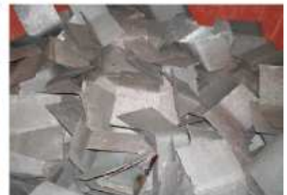
折り曲げて洗浄処理した鉄心
