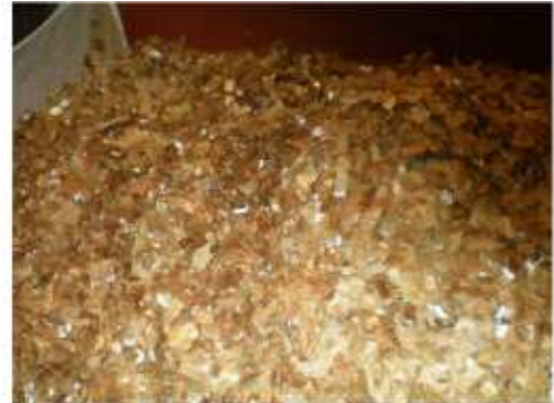
処理が完了したコンデンサ素子
