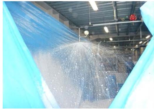
泡消火設備の噴射試験
